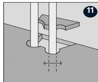
Bohren Sie entsprechende Löcher in die Dielen. Die Bohrungen sollten 20 mm größer im Durchmesser sein als die Rohre. Setzen Sie das ausgesägte Stück mit Leim wieder ein. Decken Sie die Fuge anschließend mit einer Heizkörperrosette ab.
