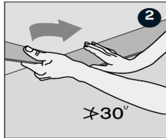
Drücken Sie die nächste Bodendiele im Winkel an die erste Dielen und drücken Sie anschließend die Dielen auf den Boden. Verfahren Sie in der gleichen Weise mit der gesamten ersten Reihe
