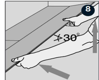
Heben Sie die Dielen (zusammen mit der vorher gelegten Dielen in der gleichen Reihe) etwa 30 mm an der Vorderkante an und drücken Sie diese in die Dielenreihe hinein. Wenn die Längskanten aufeinander stoßen, legen Sie die Dielen auf den Boden.
