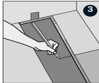
Legen Sie die letzte Dielen mit der Unterseite nach oben, die Stirnseite ohne Verriegelungsleiste der Wand zugewandt. Der Abstand zur Wand soll ca. 10 mm betragen. Markieren Sie die Stelle, an der die Dielen abgesägt werden soll.
