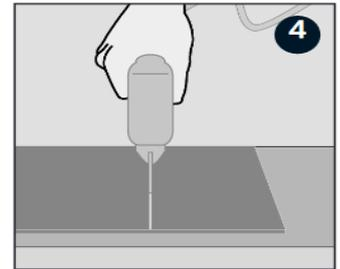
Sägen Sie die Länge zu, am besten mit Hilfe einer Stichsäge. Legen Sie die Dielen mit der Dekorseite auf die Sägeunterlage. Als Alternative kann eine feingezahnte Handsäge benutzt werden, aber dann muss die Dekorseite nach oben zeigen.
