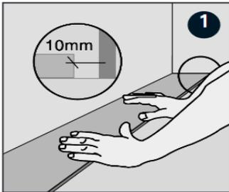
Legen Sie das erste Element entlang der Wand aus. Dabei werden die Federseiten gegen die Wand gelegt. Achten Sie darauf, dass Sie ca. 10 mm Abstand zwischen der Stirnseite der Dielen und der Wand haben. Der Abstand der Längsseite von der Wand (ca. 10 mm) kann später festgelegt werden, wenn drei Reihen verlegt worden sind
