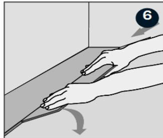
Drücken Sie die Längsseite der ersten Dielen der zweiten Reihe im Winkel gegen die davor liegende Dielen. Pressen Sie die Dielen weiter nach vorne und legen Sie sie gleichzeitig an den Boden an.
